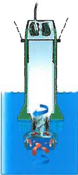
LPS pumpen skapar rotation på vattnet
